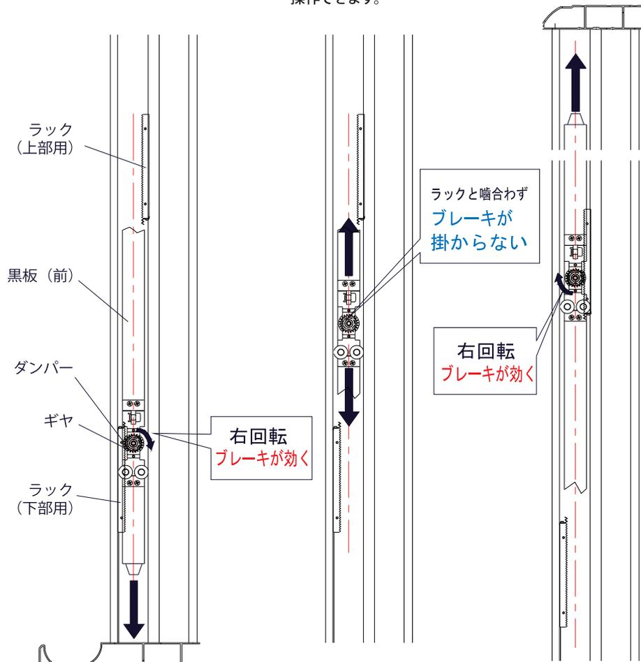
※右回転した時に抵抗を生じるダンパー使用時
